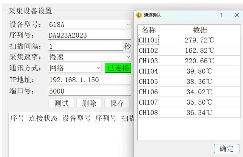
关闭“通道确认”界面后, 软件会自动保存刚刚测试连接时的相关信息到下图的列表框中, 并且连接状态为“已连接”。然后就可以切换到“数据采集”界面进行数据采集了。
