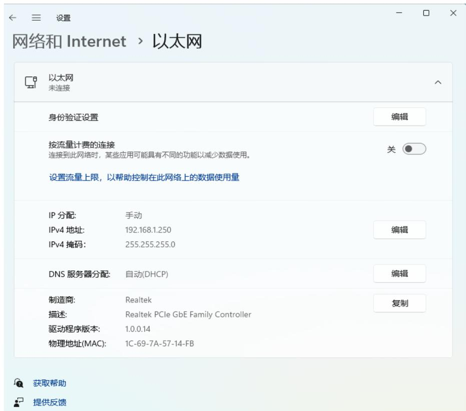
采集器其默认 IP 一般均为 192.168.1.150，端口为 5000，1611A 系列的设备可以在设备屏幕设置界面查看确认；然后将电脑的 IPV4 设置成固定 IP，并确保电脑的 IP 地址
