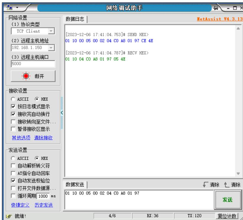
STEP4: 修改完成后，再发送一条指令 01 03 00 05 00 02 查看修改是否成功，如下图所示，返回的红色区域为设备当前的 IP 地址参数。与 STEP3 中设置一致，即表示设置成功！注意，设置成功后，需断电重启 618 设备，才能正常使用其新的 IP 地址进行网络通讯！
