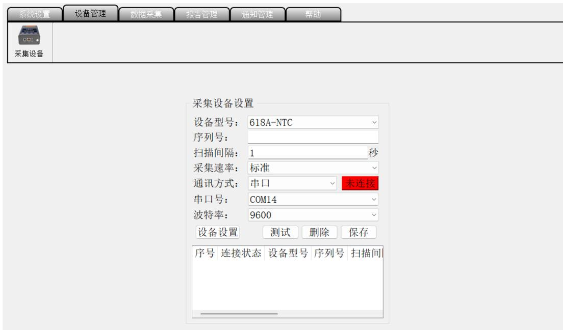
**设备型号:** 根据您的使用设备，下拉选择，支持设备型号如下图所示。包括 618A 系列、619A、1611A 系列、1612A 等。请注意，1611A 系列中标志 V1 的为我司旧款版本，V2 表示我司全新升级的版本。在软件选择设备型号前，请务必知悉您的设备具体型号，以免出现测试连接失败的情况。
