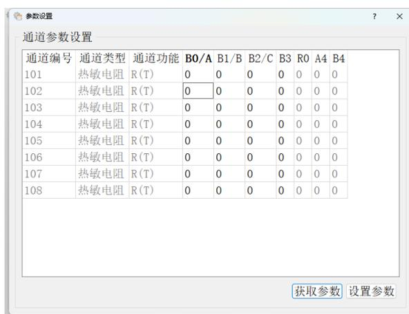
**获取参数:** 可以点击“获取参数”按钮, 查看通道的原始出库时校准系数如下图所示
