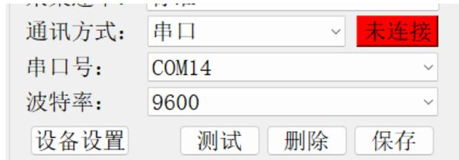
串口通讯时需要确保设备的 USB 驱动已安装，USB 通讯线已正确连接，计算机-管理-设备管理器-端口界面能正常显示设备的端口号。
