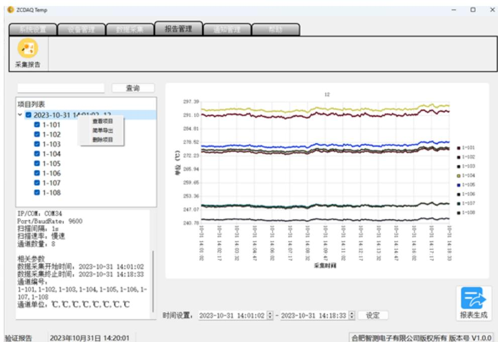
在查询框中输入需要查询的项目名称，点击“查询”按钮，即可查询项目，如果不输入直接点击“查询”按钮，则会显示查询到的所有项目信息并展示在列表中。左侧列表将会按照项目时间-项目名称的格式显示项目信息。
