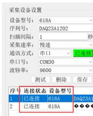
如下图所示，在“采集参数”设置界面，设置项目名称。ZCDAQ 软件支持多项目和多采集器级联的方式。如果您需要将 2 台设备的数据保存在一个项目下进行数据查看，可以按照下图所示，设置 1 个项目，2 个采集器。然后在采集器列表选择上述步骤 2 中添加的 2 台 618A 设备。
